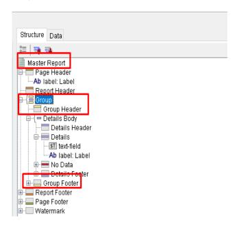
Рисунок 202 – Использование в структуре отчета группировки и форматирование.
